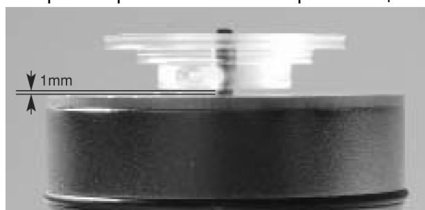
Поднимите шасси проигрывателя и ввинтите двигатель снизу точно под отверстием с заданным в шасси положением. Пожалуйста, уделите внимание тому, чтобы переключатель двигателя оказался снаружи, с левой стороны корпуса проигрывателя грампластинок. Когда двигатель окажется в правильном положении, осторожно опустите шасси.
