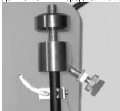
Точная настройка может быть выполнена наилучшим образом, когда проигрывается хорошо известная запись, которая должна содержать сольную партию инструмента или голоса спереди центра звуковой сцены. Если звуковой образ большемещен вправо, вы должны уменьшать антискейтинг, выворачивая винт настройки. Если звуковой образ большемещен влево, вы должны увеличивать антискейтинг, заворачивая винт настройки.
