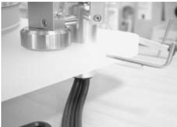
Когда тонарм закреплен, вы можете подсоединить звукосниматель к тонарму. Направляющая в головке звукоснимателя упрощает сборку. Пожалуйста, закрепите звукосниматель при помощи винта и соответствующего шестигранного ключа, когда звукосниматель расположен на нижнем порожке (см. рисунок). В этом положении звукосниматель и тонарм будут автоматически иметь правильный угол и оптимизированный наклон.
