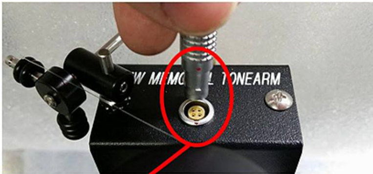
Совместите красную точку на разъеме Lemo с красной точкой на приемнике на блоке разъемов
